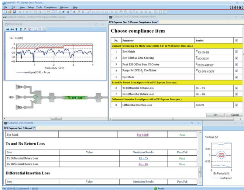
Рис. 2 Результаты симуляции интерфейса PCIe Gen3 SerDes, включая модели IBIS AMI и взаимовлияние близлежащих каналов.
