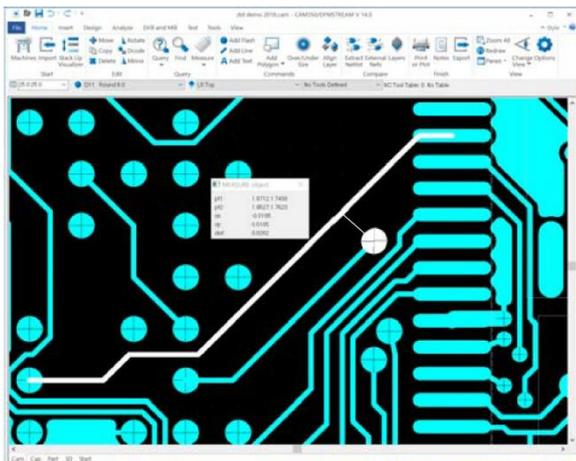
Инструмент измерения расстояний
