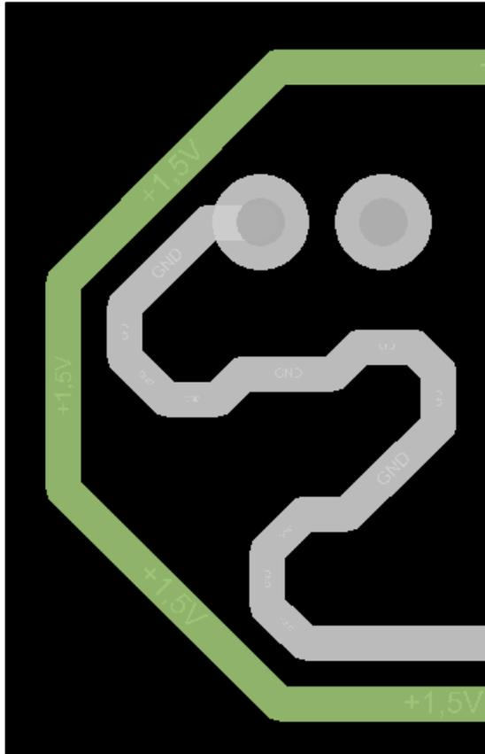
Рис. 6.7 Зелёная линия трассируется с Smooth=Minimal. Режим Hug Only.
