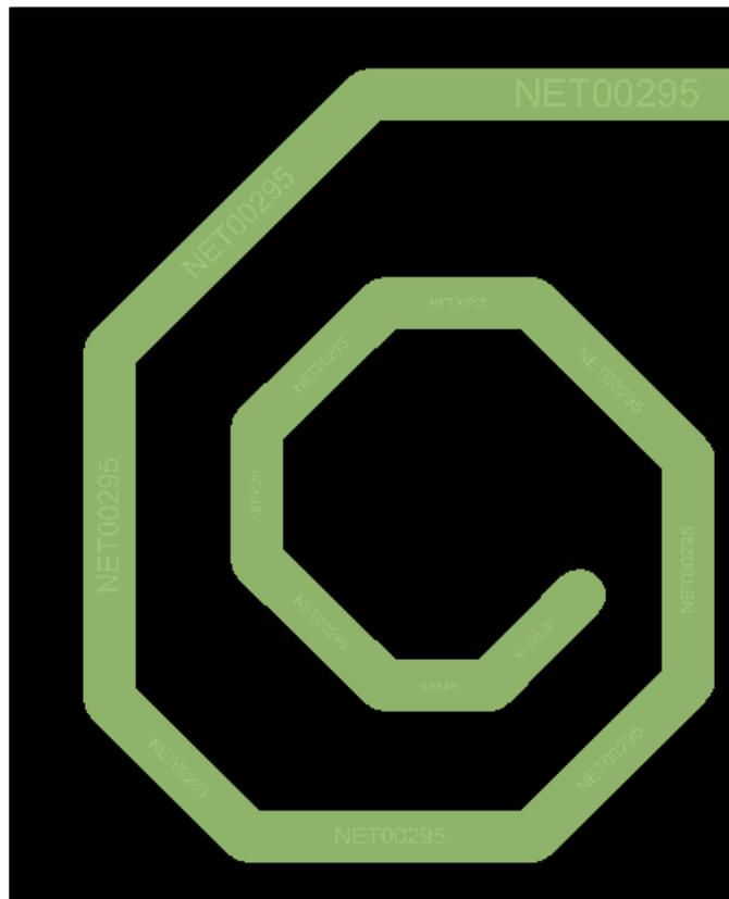
Рис. 6.6 Линия поворачивает с большим радиусом. Величину скоса под 45 градусов пользователь пока что определяет сам.
