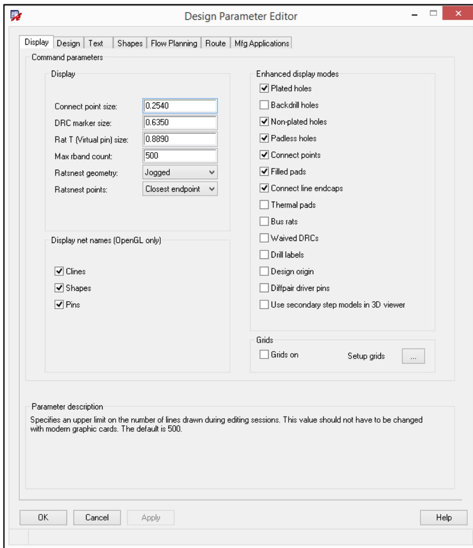
Рис. 1.32 Один из вариантов настроек визуального отображения проекта ПП.
