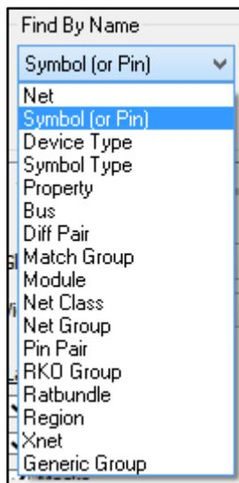
Рис. 1.26 Типы объектов, которые можно искать при помощи Find by Name.
