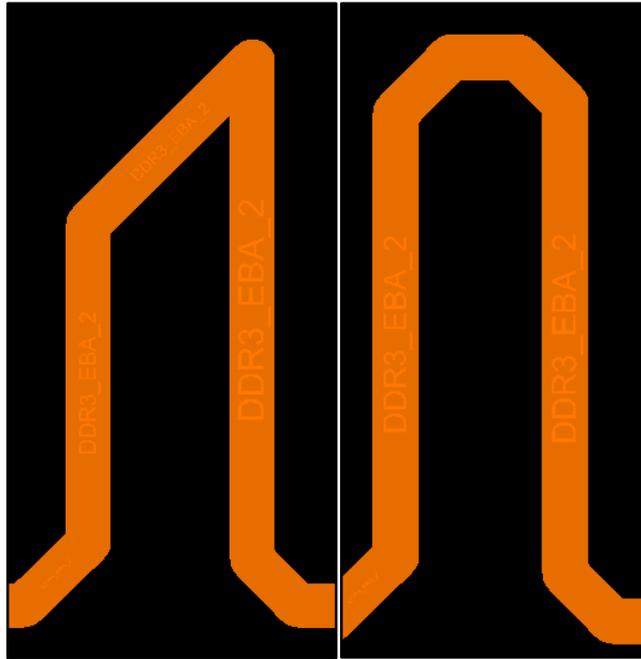
Рис. 1.79 Иллюстрация работы настройки Line corner.
