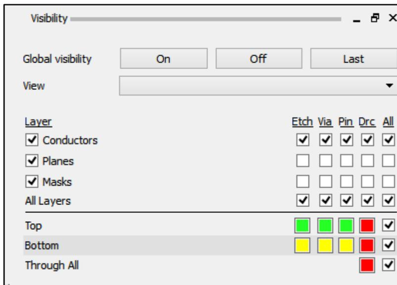
Рис. 1.117 Одно из состояний окна Visibility для случая двусторонней ПП.
